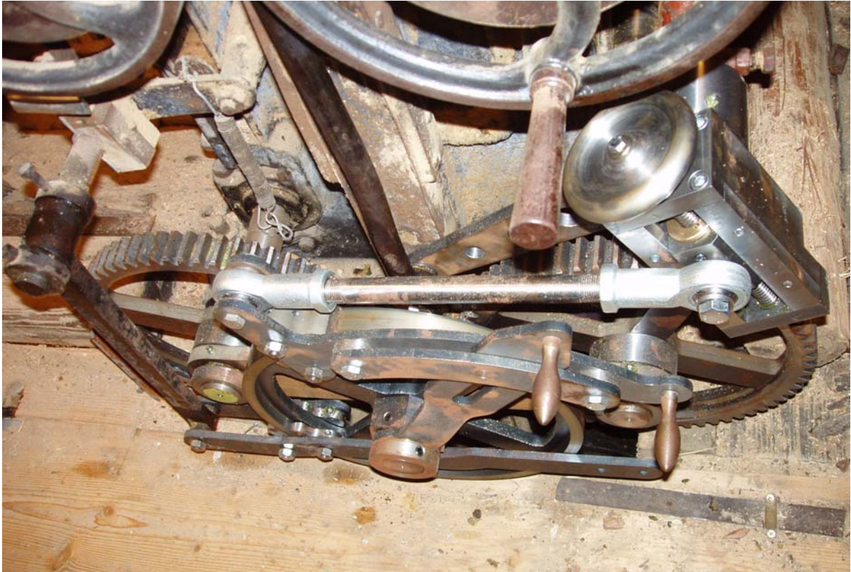
Abb. 9: Der Vorschubantrieb von der Bedienseite aus gesehen.
