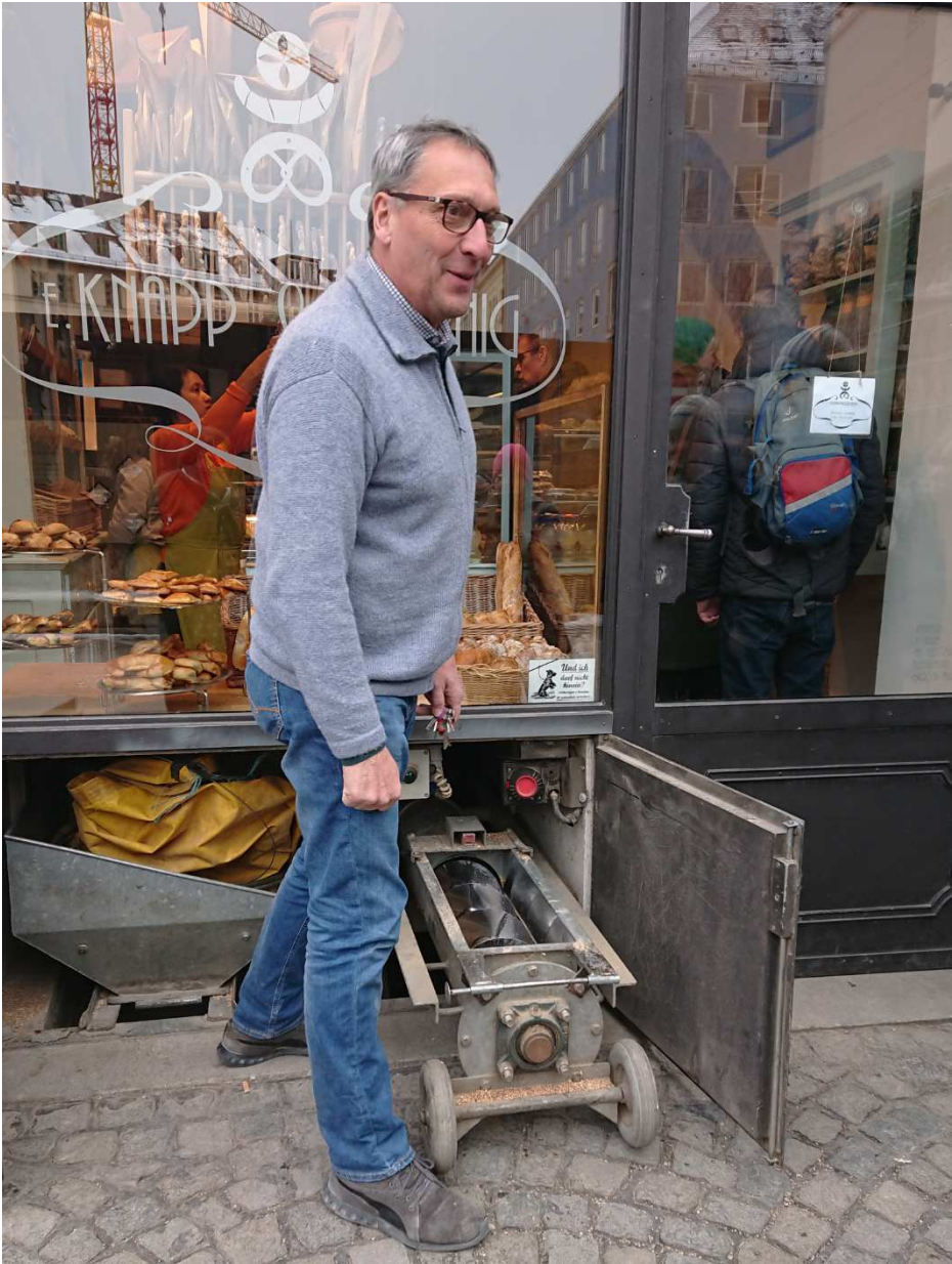
Abbildung 4: raffiniertes technisches Schmankerl: die Annahmeschnecke unter der Ladentheke
