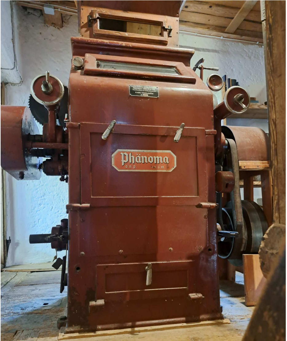
Abbildung 14: Die Soder-Mühle zur Auflösung von feinem Gries von Liebeck in Kassel
